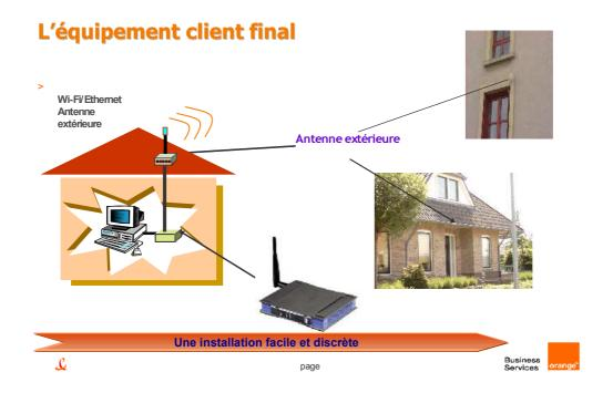
adsl : technologie qui permet de véhiculer le haut-débit par le câble téléphonique. Wi-fi : technologie qui apporte le haut débit par ondes hertziennes d'où l'appellation WI-FI signifiant « sans fil »
